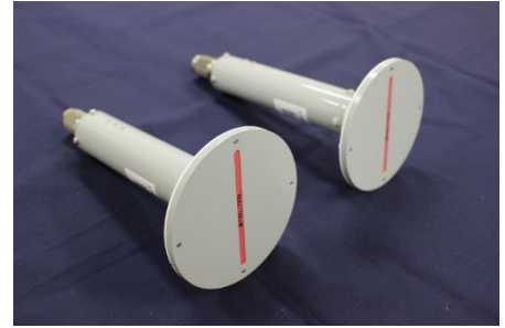
7GHz帯 放射器単体 (赤ラインは偏波を表示)
