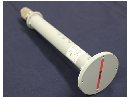
10GHz帯 放射器単体 (赤ラインは偏波を表示)
